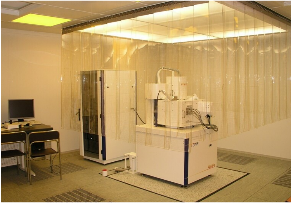
Obr. 29: Aparatura pro litografii elektronovým svazkem ve FZÚ AV ČR
